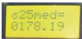
Genererà altresì in uscita un segnale in corrente  $I_{OUT}$  (isolato galvanicamente dall'alimentazione) proporzionale alla  $\sigma_{25med}$ , che può essere collegato direttamente all'ingresso analogico di un PLC (la resistenza massima caricabile è pari a 500  $\Omega$ ).
