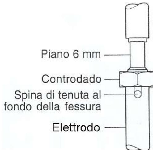
5. Sostenere l'insieme ed inserire la spina di fissaggio finché le sporgenze dai due lati dell'elettrodo siano uguali.
