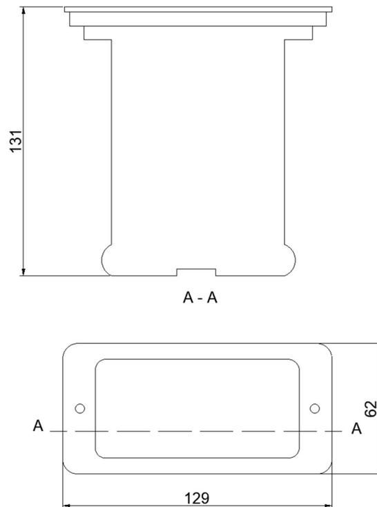
L'interruttore può essere montato sulla portella del quadro elettrico di controllo della caldaia, usando il kit di accessori in dotazione comprendente una guarnizione in gomma, una cornice e 2 viti di fissaggio.
